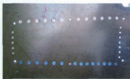
图5 复材螺栓连接试验一无损探伤结果
