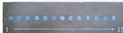
1、4、7、10、13号孔为正常孔,2、5、8、11为有意制成的斜孔,并倒R角,3、6、9、12号孔为正常孔未倒R角。
